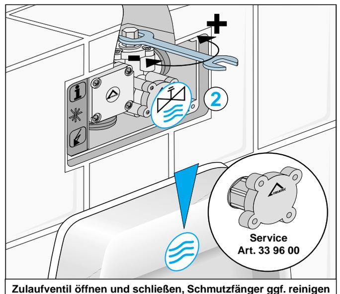
Zulaufventil öffnen und schließen, Schmutzfänger ggf. reinigen
