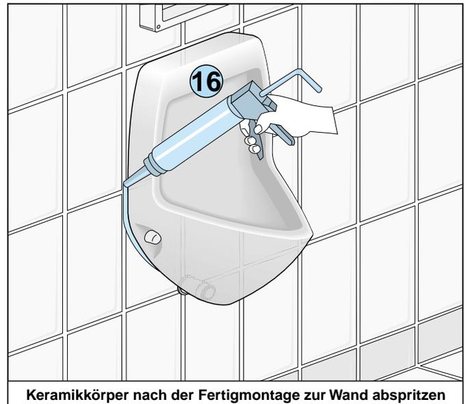
Keramikkörper nach der Fertigmontage zur Wand abspritzen
