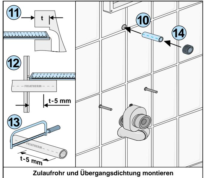
Zulaufrohr und Übergangsdichtung montieren
