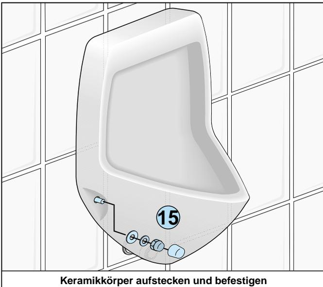
Keramikkörper aufstecken und befestigen
