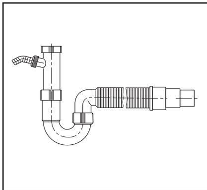
Rohrgeruchverschluss mit flexiblen Schlauch (gesteckt) mit Geräteanschluss G1
