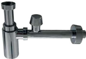
Verlängerungsrohr mit Muffe L = 125 mm, ø 32, Messing verchromt, mit hochglanz- verchromtem Rohrbelüfter G ½, Typenklasse A II, Volumenstrom 2 L/s, Temperaturbereich 0°C bis +60°C
