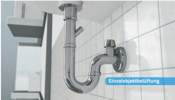
Rohrbelüfter für Einzelobjektbelüftung nach DIN EN 12380 Typenklasse A II, Volumenstrom 2 L/s bis 3,3 L/s, Temperaturbereich 0°C bis +60°C
